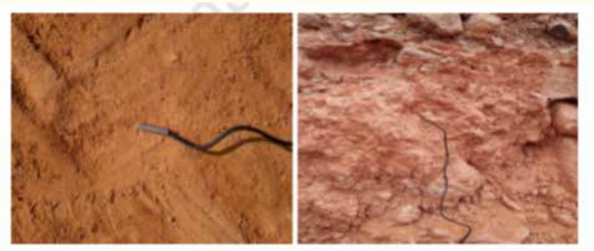
شکل ۲. پراب دمایی TM-2 نفوذ کرده در ۱۰ سانتی متر داخل لایه خاک
